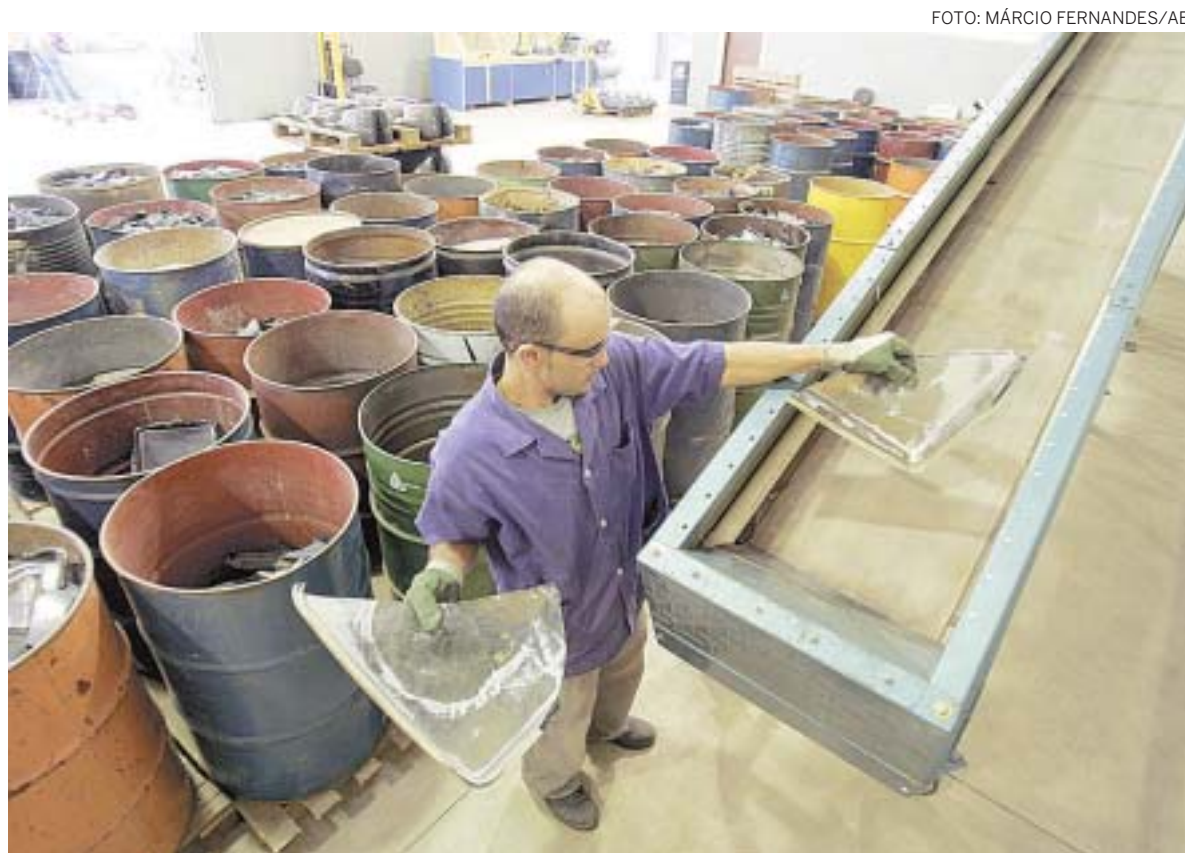
SUCATA - Planta da Ativa Reciclagem processa até 4 mil monitores de CRT e televisores ao mês, mas tem capacidade para 20 mil
